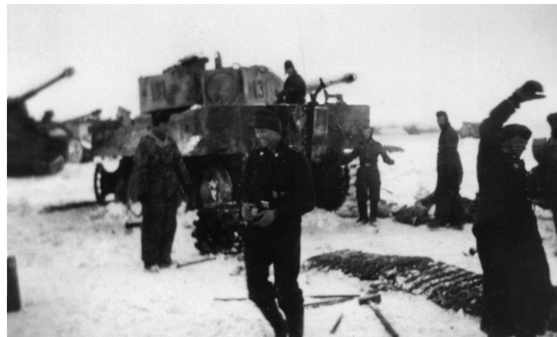
131-ojo Tigro varytuvo remontas. Toks darbas šaltos žiemos sąlygomis buvo ypač sunkus.
