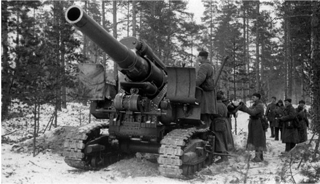
Suomių betoniniams įtvirtinimams griauti Raudonoji armija pasitelkdavo 203 mm kalibro haubicą B-4. Pabūklo greitošauda – 1 šūvis per dvi minutes. B-4 sviediniai galėjo pasiekti net už keliolikos kilometrų esančius taikinius.
